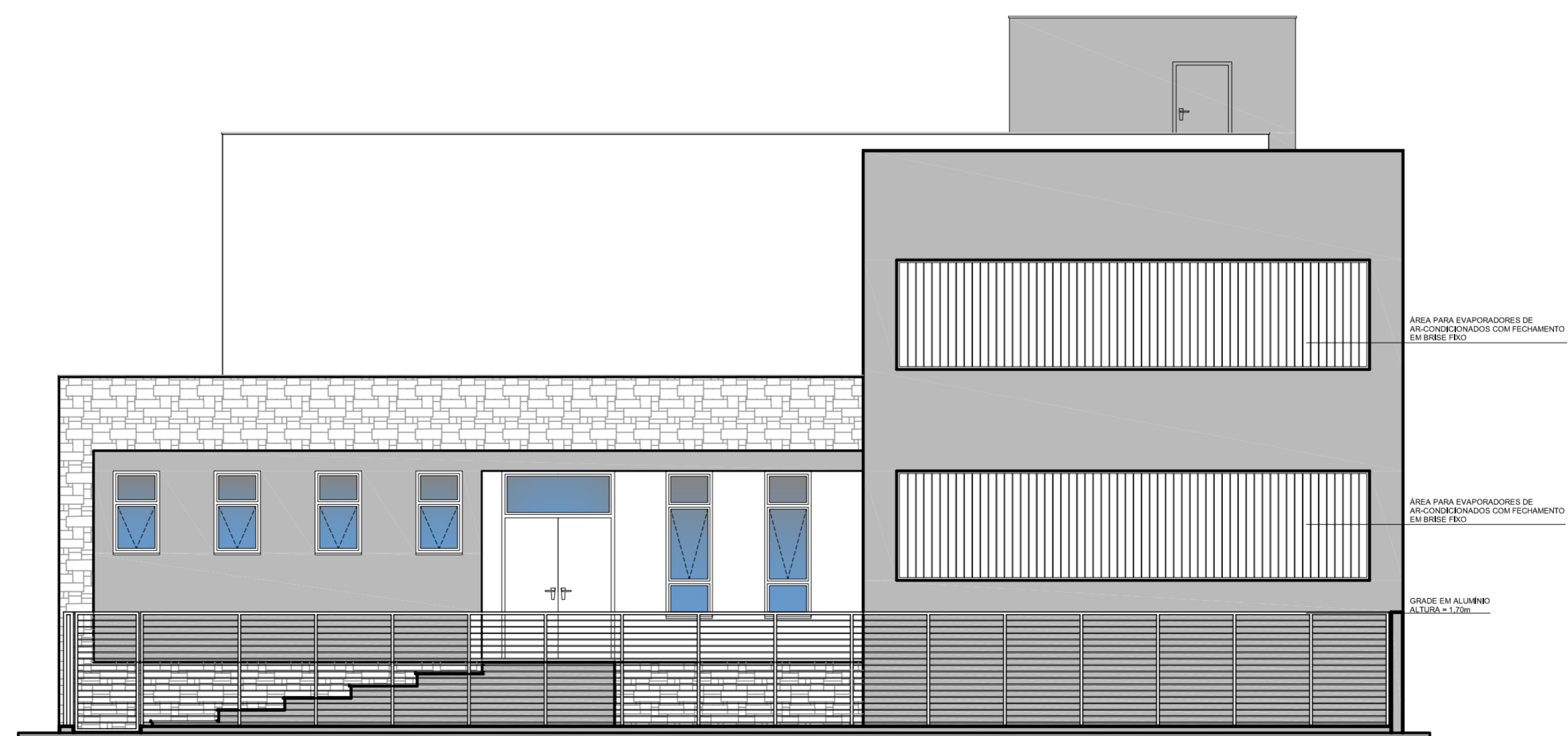
FACHADA OESTE - TRAV. VEREADOR WALTER KERN ESCALA 1:75 COM BRISES E GRADE METALICA
